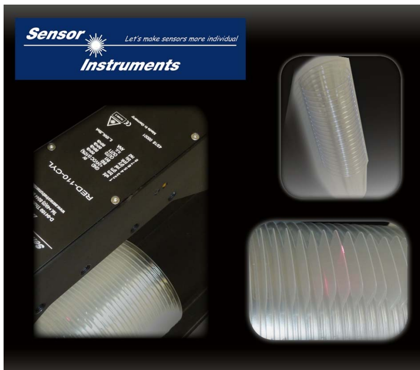
El detector de bordes de la serie RED al detectar y contar la tapa de plástico
